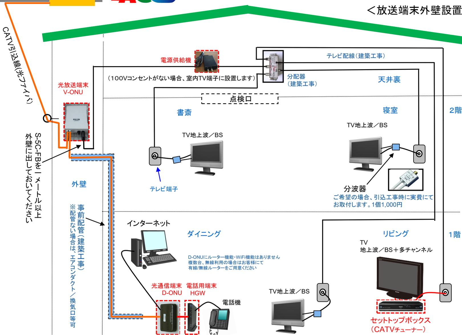
※ 橙色/赤色部分の配線、機器設置工事はケーブル局が行います。(CATV引込線、光放送端末、各サービス用宅内機器)
